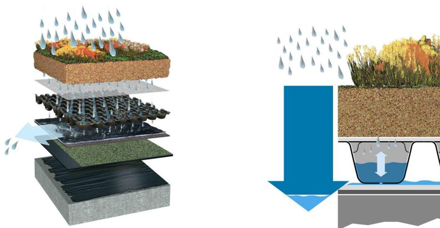
Dans les systèmes définis aux paragraphes 7.1 et 7.2, il est possible de substituer les éléments de drainage par l'élément Bauder RE 40 à associer au géotextile Bauder FSM 600 ou Bauder FSM 800.
