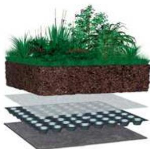
L'épaisseur totale du complexe depuis le géotextile de protection jusqu'au substrat est comprise entre 16 et 34 cm environ selon l'élément de drainage utilisé. La pente est comprise entre 0 et 5 %.
