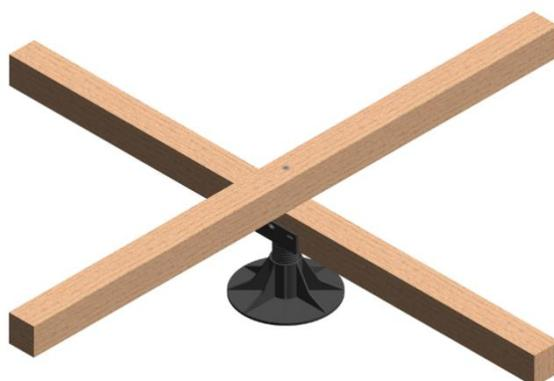
Figure 9 – Lambourdage croisé – Exemple de fixation des lambourdes entre elles
