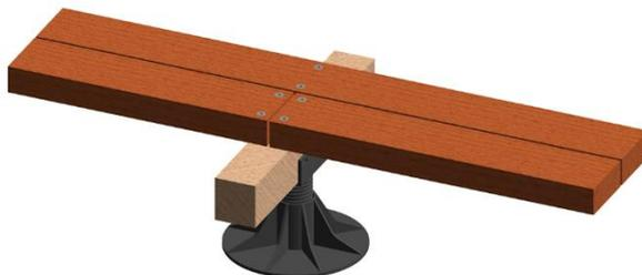
Figure 1 – Principe de pose du lambourdage simple
